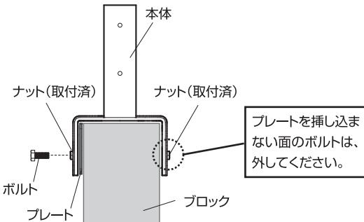
ナットは本体両面に付いていますが、ボルトは設置場所に合わせて片側の面のみに取り付けてください。(ボルト2本で固定します)
