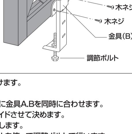
■ 金具Aに調整ボルトを取り付けます。
