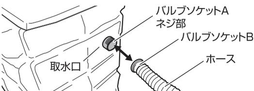
②別売の**雨水タンク取水器セット**の**バルブソケットA**と**バルブソケットB**を接続します。**ホース**に**バルブソケットB**の先端をまわしながら接続します。
