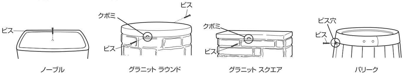
**レインボウル**フタ上面に丸い印があります。丸い印のある位置でフタ側面に**ビス**を取り付けます。(図①)
