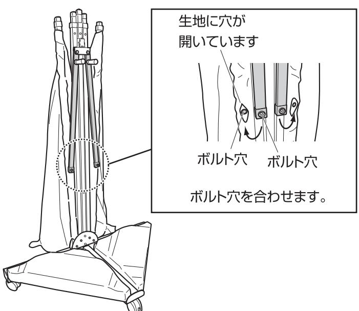
4. ボルトで生地を固定します。(計2カ所)
