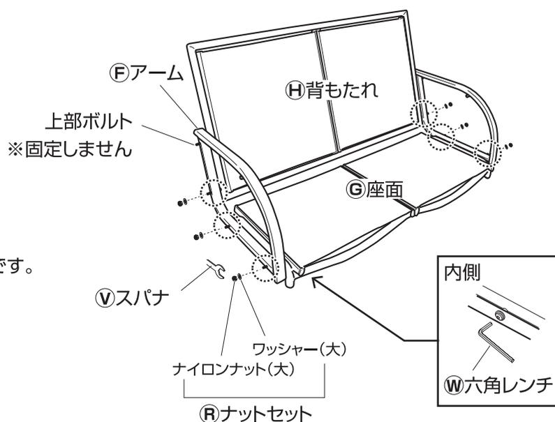
3. ⑧背もたれの上部ボルトに⑫吊棒(長)のボルト穴を合わせ、⑩ナットセットで本締めします。(計2カ所)
