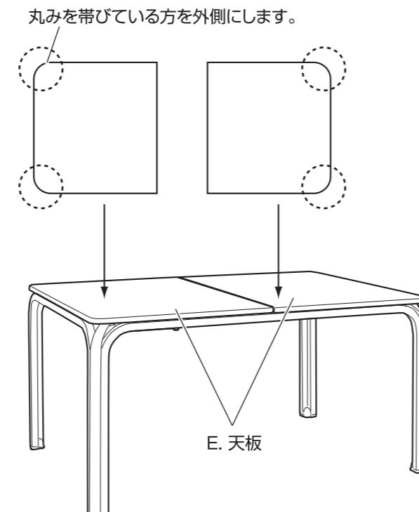
②C.サポート脚(大)のレールにL.丸頭ボルト(短)を取り付け、E.天板とC.サポート脚(大)を固定します。(計8カ所)
