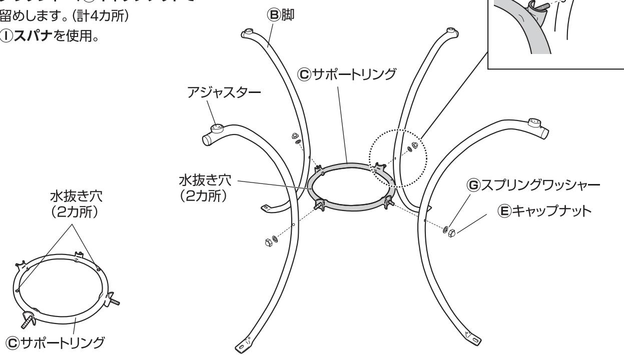
※⑬サポートリングは水抜き穴がある面を「脚の先端側」にします。
