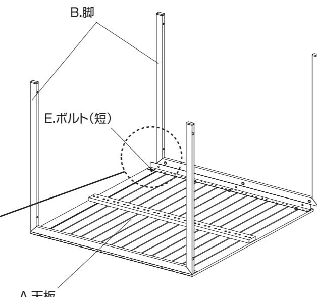
**組立方法****2 脚を取り付けます**①B.脚とC.脚をD.ボルト(長)で仮留めします。
