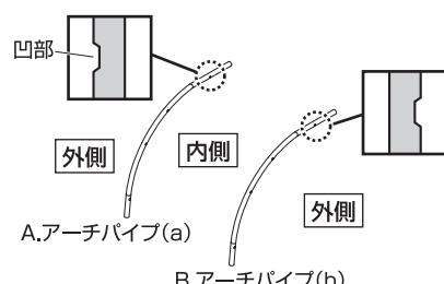
●先端からボルト穴までの距離が長い側を上にします。
